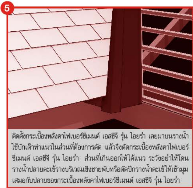
กรณีที่เป็นรางน้ำทางเดียว ให้พื้ปลายขอบที่บริเวณร่องรางน้ำของรางน้ำตะเข้ เอสซีจี กัลวาไนซ์เคลือบสี สำหรับหลังคาทุกประเภท เพื่อทำเป็นคั่นกันน้ำ และยึดปีกรางน้ำทั้งสองข้างเข้ากับแปคู่บนด้วยตะปูเกลียวปลายส่วน 32 มม. สำหรับยึดหลังคาไฟเบอร์ซีเมนต์ เอสซีจี รุ่น โอयर่า
