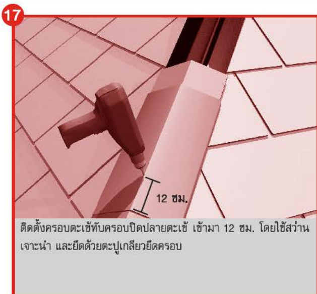
ยึดครอบ 3 ทาง โดยวัดจากริมแผ่นเข้ามาด้านละ 12 ซม. ยึดด้วยตะปูเกลียวยึดครอบจำนวน 3 จุด (ตั้งรูป) และติดตั้งครอบสลับหลังคาตัวต่อๆ ไปจนบรรจบกับครอบ 3 ทางอีกด้านหนึ่ง
